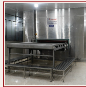
Băng chuyền đông nhanh với hệ thống tái đông: 1 x 500Kg/1h MQF (Multi-purpose Quick Freezer) with Re-freezing system: 1 x 500kg/1h
