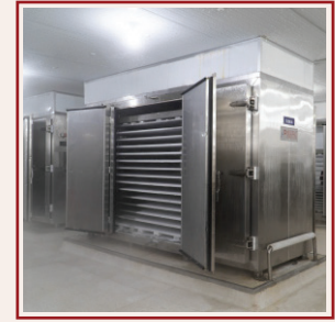
Tủ đông tiếp xúc: 4 x 1.8tấn/2h/lần Contact freezer: 4 x 1.8mt/2h/time
