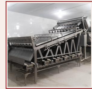
Máy phân cỡ tôm: 1 x 3tấn/1h Shrimp grader : 01 x 3mt/1h
